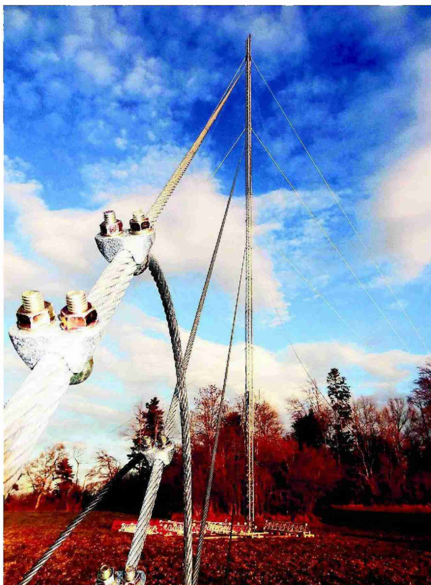
Der Messmast soll Aufschluss über die Windverhältnisse im Gebiet des geplanten Windparks Burg/Mühlacher in Kienberg geben. CHR
